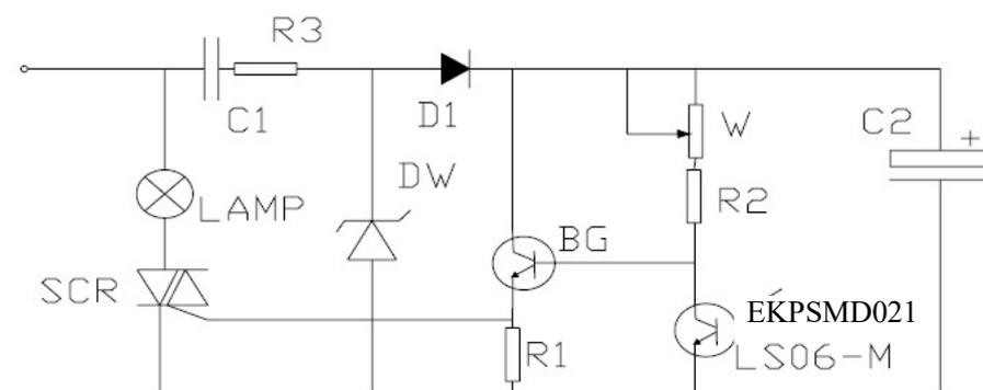
上图为光控路灯电路，白天路灯熄灭，夜间路灯自动点亮。图中，电容 C1、C2、R3 和二极管 D1 及稳压管 DW，组成简单的电容降压整流电路，接通电源后获得 12V 左右的直流电压。三极管 BG、环境光探测器 EKPSMD021 和双向可控硅等，组成光电开关电路。
