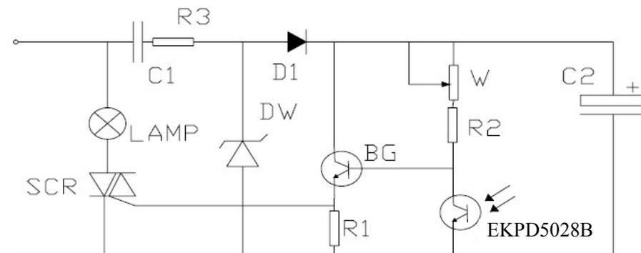
上图为光控路灯电路，白天路灯熄灭，夜间路灯自动点亮。图中，电容 C1、C2、R3 和二极管 D1 及稳压管 DW，组成简单的电容降压整流电路，接通电源后获得 12V 左右的直流电压。三极管 BG、环境光探测器 EKPD5028B 和双向可控硅等，组成光电开关电路。
